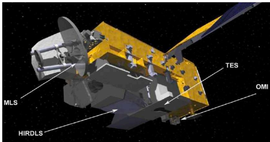
Nota. Modelo del Satélite Aura, mostrando los cuatro instrumentos de medición. Tomado de [21].
