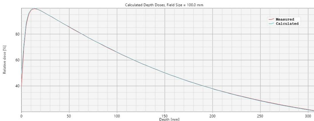
**Figura 4.7.** Gráfica de comparación del PDD medido y el PDD calculado por el TPS para el tamaño de campo de referencia, 10 cm x 10 cm. Fuente: imagen propia.
