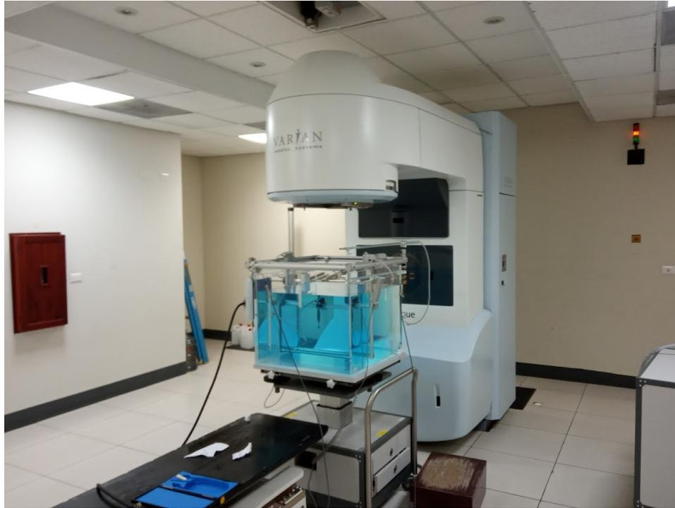
**Figura 3.6.** Posicionamiento del sistema Blue Phantom<sup>2</sup>. Fuente propia.
