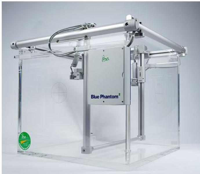
**Figura 3.2.** Sistema Blue Phantom<sup>2</sup>. Fuente: imagen tomada de [22].
