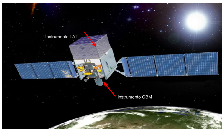
Figura 4.3. Telescopio Espacial de Rayos Gamma Fermi. Créditos:Michelson y cols. (2010)
