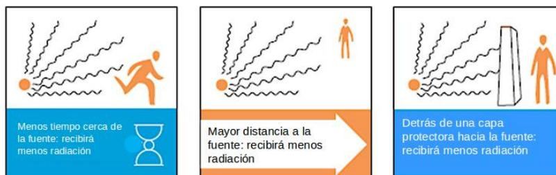
**Figura A.1.** Esquema y descripción del principio ALARA.
