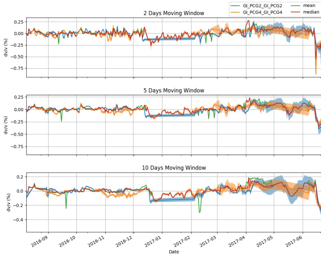
**Figura 4.2.** Valores relativos de velocidad correspondientes a la autocorrelación de PCG2 y PCG4. Es posible visualizar las contribuciones individuales de cada estación al promedio de la velocidad y cómo la falta de datos afecta dicha contribución.
