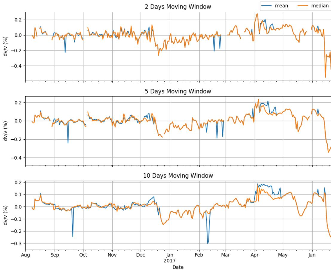
**Figura 4.1.** Valores de velocidad relativa (o perturbaciones en la velocidad sísmica) usando las funciones de autocorrelación y correlación cruzada.
