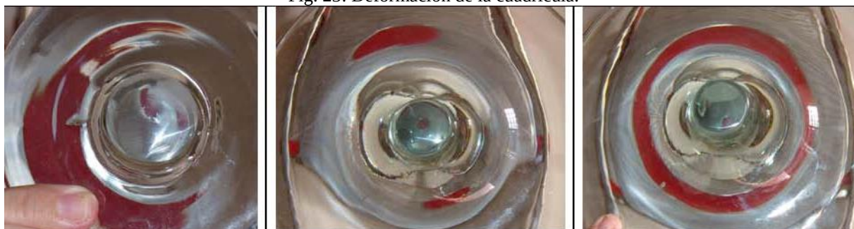
Fig. 24a, 24b y 24c: El pie de copa es un simulador de diversos objetos: segmentos de arco, imágenes de la cruz y anillo de Einstein
